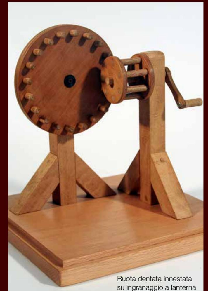
Ruota dentata innestata su ingranaggio a lanterna
