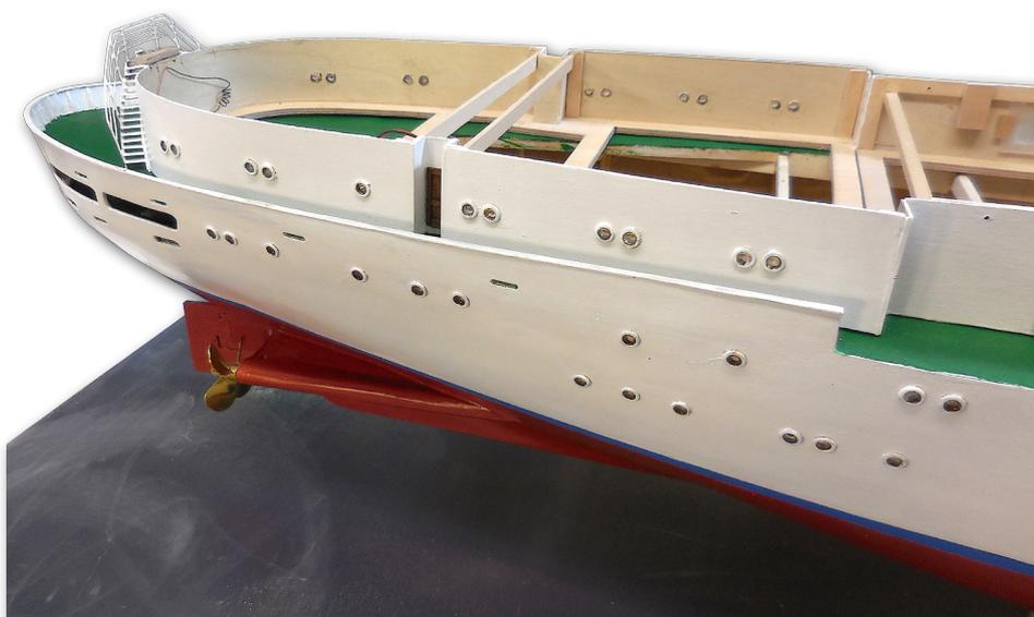
Una caratteristica della Mn Italia sono le scialuppe incassate all'altezza del ponte di coperta. Dopo aver costruito e rifinito le scialuppe le ho montate su due strutture, una per il lato di Dritta e l'altra per il lato di Sinistra. Sotto queste strutture sono alloggiati dei microled che illuminano i fianchi dello scafo.
