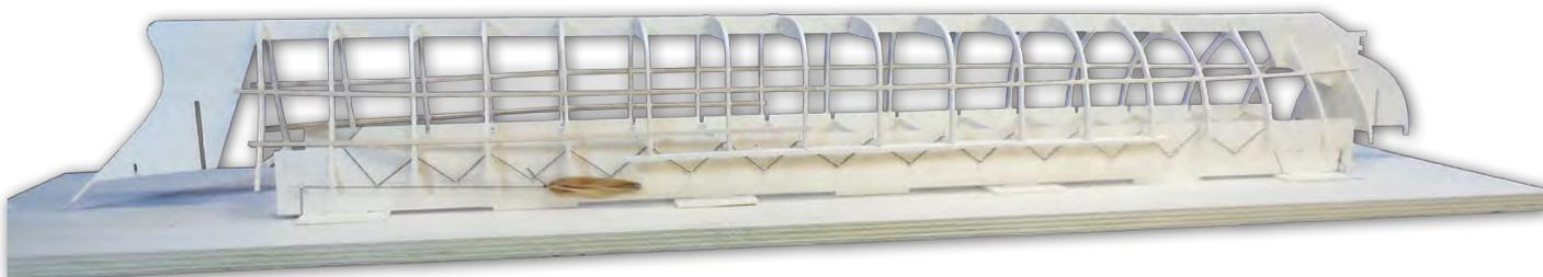
Lo scheletro, nonostante il percorso rocambolesco per risalire al piano di costruzione, è risultato perfettamente allineato e non ha richiesto aggiustamenti. Ho potuto così procedere con l'applicazione del fasciame che è costituito da strisce di compensato di betulla dello spessore di 1,5 mm.
