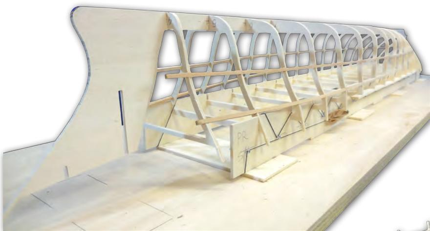
Per montare l'intera struttura in modo che rimanesse perfettamente allineata ho usato una spessa tavola di compensato sulla quale ho fissato due liste di compensato da 5 mm, dotate di incastri, nei quali ho inserito i bagli delle ordinate, preventivamente dotati di incastri.
