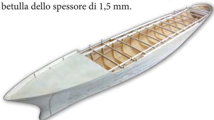
Terminato il montaggio del fasciame ho applicato, all'interno dello scafo, un abbondante strato di resina epossidica, sostenuta da tessuto di cotone, con lo scopo di irrobustirlo e prevenire possibili fessurazioni.
