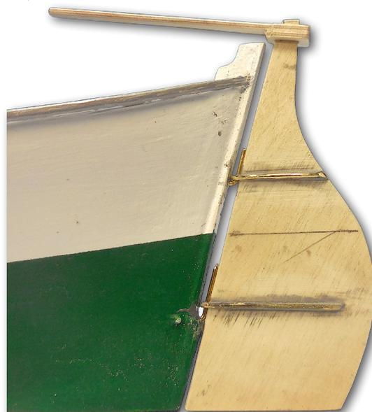
Nella foto qui sopra si vede il timone, ancora grezzo, in un primo montaggio di prova. A destra si vede il timone montato e già trattato con una prima mano di vernice.
