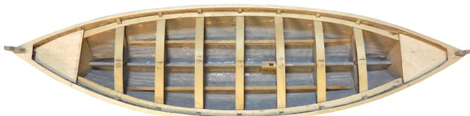
Dopo aver installato i banchi bisogna montare i trincarini. Ovvero due tavole, una per lato, che si sovrappongono ai banchi seguendo la forma interna dello scafo.
