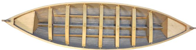
**Installazione dei banchi** - Adesso i nostri banchi sono pronti per il montaggio. Dispongono di un puntale, già tagliato a misura, degli incastri per adattarsi alle ordinate e, su queste, delle mensole di appoggio.
