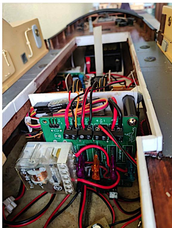
I due motori sono gestiti da un ESC (Electronic Speed Control) della Sabertooth (Sabertooth Dual 12A 6V-24V Regenerative Motor Driver) in modo indipendente per ottenere una direzionalità separata che, oltre ad assicurare la navigazione avanti/indietro (funzionalità mixed), può collaborare con il timone per la direzione (funzionalità indipendente); ciò è ottenuto collegando l'ESC al ricevitore con ch1 e ch4.
