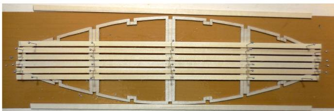
L'applicazione dei listelli inizia dai due centrali e, via via, si incollano quelli sempre più esterni. Per la distanza fra i listelli si possono usare dei pezzetti degli stessi listelli, che sono spessi 1,5 mm, che vengono provvisoriamente inseriti prima del fissaggio.
