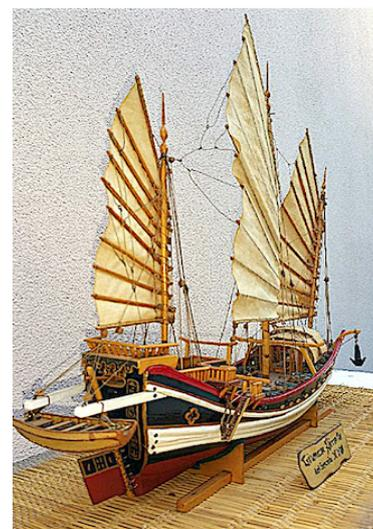
Sono costruite al terzo, ovvero possono essere ripiegate su se stesse per diminuire l'esposizione al vento. Questa operazione è consentita da una serie di canne di bambù con trozze scorrevoli lungo l'albero.
