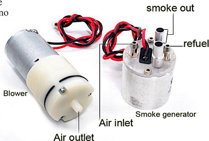
Il dispositivo è composto di due parti, il generatore di fumo (smoke generator) e la pompa (blower) che collegata da un tubo al generatore immette aria (air inlet) facendo uscire fumo dallo “smoke out”.
