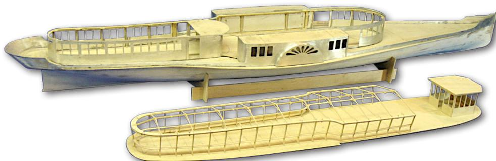
Ho rispettato rigorosamente le dimensioni del progetto rifiutandomi di ricorrere al trucco di aumentare il volume di carena per guadagnare un po' di spinta. Ho preferito realizzare una costruzione la più leggera possibile con una accurata distribuzione dei pesi.
