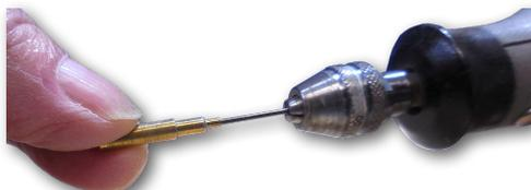
In queste tre immagini si vede la dima e il taglio del filo, il foro centrale e l'inserimento del led. Questo, dopo aver infilato i fili nel foro, va tirato delicatamente fino a portare la sorgente luminosa al centro del "tubetto".
